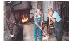
**Le fer**, fourni par Gantois à Jussey ou Renaud à Scey/s/Saône, arrivait en barres. Il fallait le porter au rouge et le battre sur l'enclume avec le marteau de forge (2,5 kg). Les grosses pièces étaient forgées en plusieurs fois avec de grosses masses selon un rythme soutenu. On faisait aussi tous les outils pour les jardins (pioches, binettes, etc) et les pièces agricoles notamment les faux dont on rabat le rebord sur une petite enclume spéciale à rabattre les faux.
